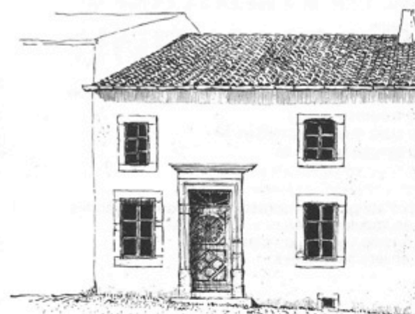
3 - Pays de Nied. Saint-Bernard. Tuile-canal. Moellon et pierre de taille en grès (pierre de sable). Crépi à la chaux aérienne.
